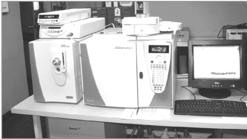
ภาพที่ 2.11 เครื่องแกสโครมาโทกราฟี/แมสสเปกโตรมิเตอร์
